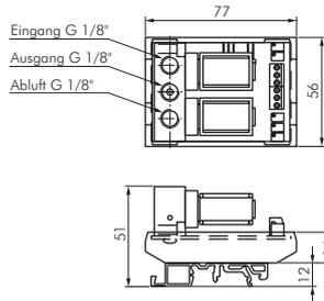
**Anwendung:** Der Proportionaldruckregler regelt den Druck auf der Sekundärseite proportional zu einem elektrischen Eingangssignal (0-10 V oder 4-20 mA). Aufgrund des geringen Durchflusses des Reglers für DIN-Schieneinstallation, empfiehlt sich dieser als im Schaltschrank verbauter Pilotregler für einen ferngesteuerten Druckregler Typ DRi (Seite 401) oder FDRi 03 (Seite 402).
