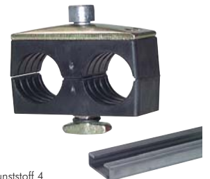
Typ Kunststoff 4 Doppelrohrschelle mit Deckplatte und Tragschienenmutter Typ KMA zum Aufbau auf C-Tragschiene TS 28 ... (Seite 247)
